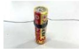
(2) コイルの両端の導線を、コイルを束ねるように2～3回巻き付ける。
